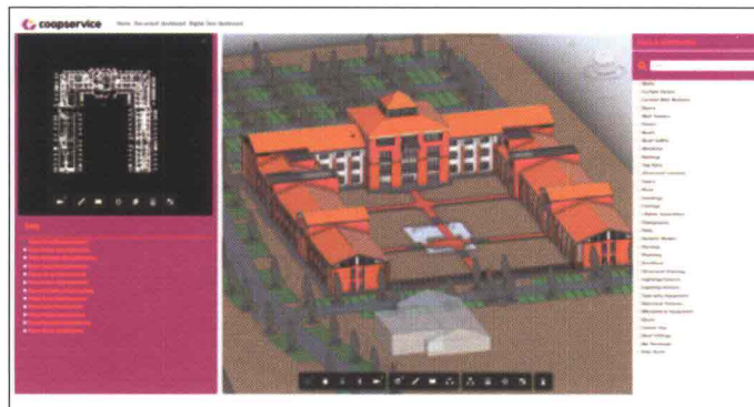
Piattaforma Coopservice Digital Twin: modello BIM ed elaborati grafici planimetrici Sede Centrale Coopservice
